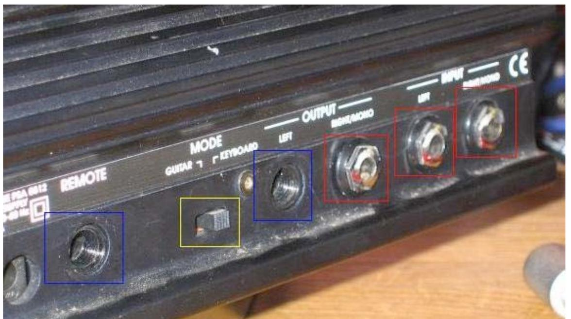
**Bild 5 Lösen der Anschlussmuttern auf der Gehäuserückseite**
