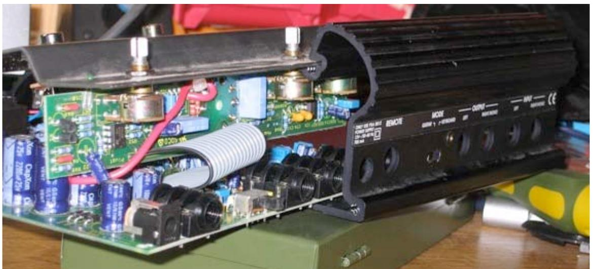
**Bild 13 Einschieben der Deckplatte**
