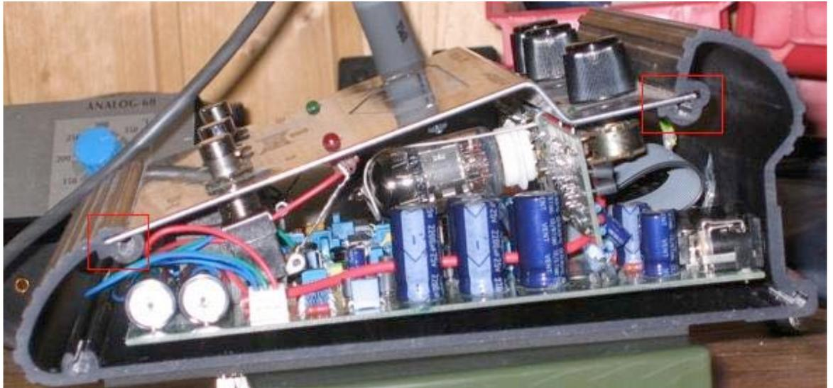
**Bild 6 Abziehen der Gehäuseplatte**
