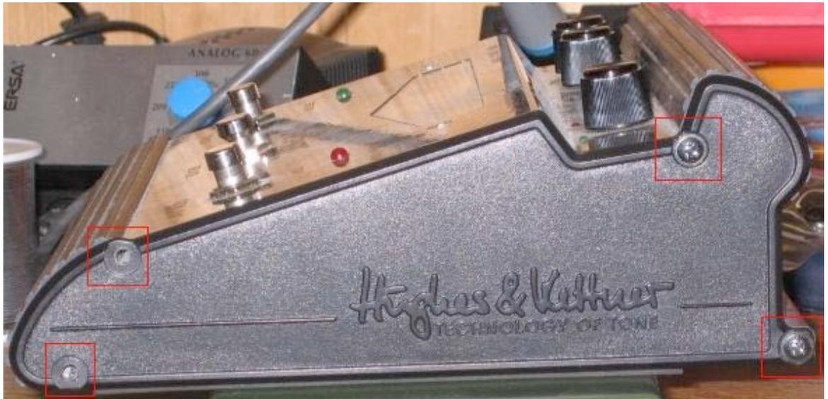
**Bild 2 Lösen der vier Seitenschrauben**
